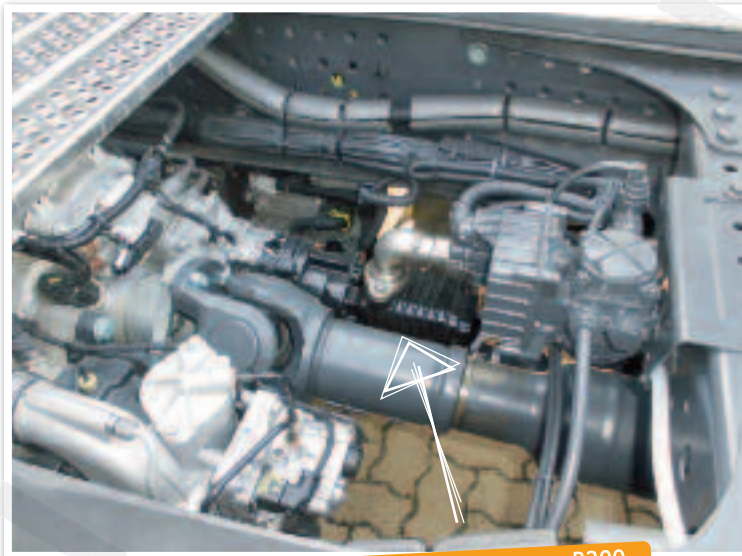
Der Schraubenkompressor B200 im Detail und im montierten Zustand: Dank kompakter Bauweise ist das Bauteil (schwarz) einfach zu platzieren.
