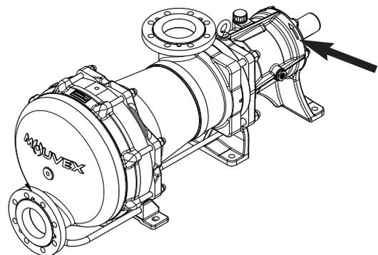
Vom freien Wellenende aus gesehen ist die Drehrichtung im Uhrzeigersinn, vom Deckel aus gesehen ist die Drehrichtung entgegen dem Uhrzeigersinn. Falls die Pumpe entgegengesetzt läuft, führt das zu keiner Beschädigung der Pumpe, es baut sich allerdings kein Druck auf.
