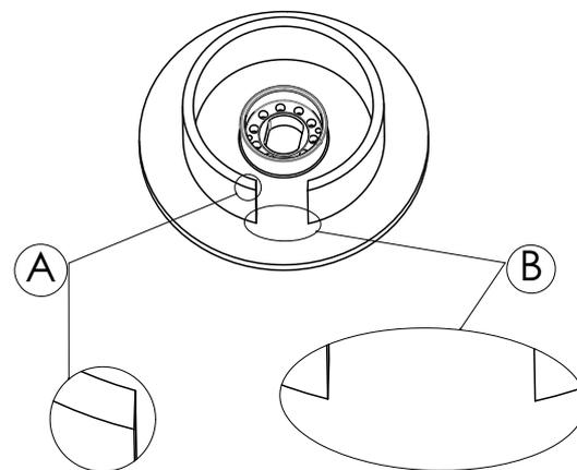
**Keine anderen Oberflächen des Kolbens nachbessern**, da dadurch die Pumpenleistung und -Standzeit verringert werden können. Insbesondere darf der Ring nicht abgerundet oder angeschrägt werden.
