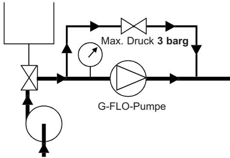
Es wird empfohlen, die G-FLO-Pumpe während der CIP-Reinigung zu stoppen, ein Start/Stop-Betrieb bei niedriger Drehzahl (< 100 1/min.) ist möglich. In einigen Fällen übersteigt der für die Anlage erforderliche Reinigungsdruck 3 barg. In diesem Fall wird ein Bypass empfohlen und die Reinigung ist in 2 Stufen durchzuführen.
