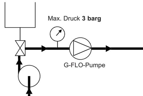
Es wird empfohlen, die G-FLO-Pumpe während der CIP-Reinigung zu stoppen, ein Start/Stopp-Betrieb bei niedriger Drehzahl (< 100 1/min.) ist möglich.
