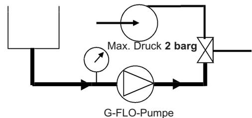
Wir empfehlen in diesem Fall eine niedrige Drehzahl für die G-FLO-Pumpe.
