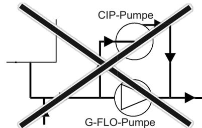
In diesem Fall ist der Eingangsdruck niedriger als der Druck auf der Druckseite der G-FLO-Pumpe, der Kolben wird somit in den Zylinder gedrückt und der Durchfluß nicht mehr gewährleistet. Eine gründliche Reinigung kann nicht garantiert werden, darüber hinaus steigt der Verschleiß am Kolben-Zylinderpaar.
