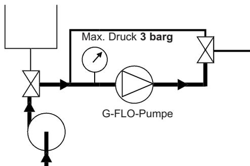
Es wird empfohlen, die G-FLO-Pumpe während der CIP-Reinigung zu stoppen, ein Start/Stop-Betrieb bei niedriger Drehzahl (< 100 1/min.) ist möglich.
