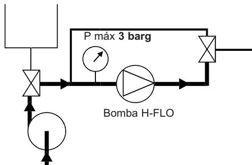
Es preferible no hacer funcionar la bomba H-FLO durante el CIP, pero se acepta una velocidad baja (< 100 rpm) o funcionamiento /parada alternada.
