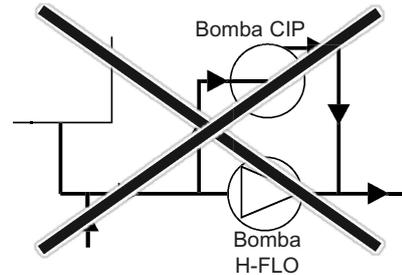
En efecto, en este caso, la presión a la entrada de la bomba H-FLO es inferior a la presión en salida y el pistón permanece pegado sobre el cilindro. Entonces la bomba H-FLO ya no es pasante. Por lo tanto, ya no se asegura su correcta limpieza y el conjunto cilindro/pistón se desgastará prematuramente.
