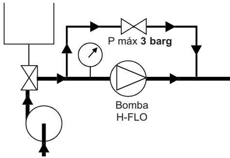
Es preferible no hacer funcionar la bomba H-FLO durante el CIP, pero se acepta una velocidad baja (< 100 rpm) o funcionamiento /parada alternada.
