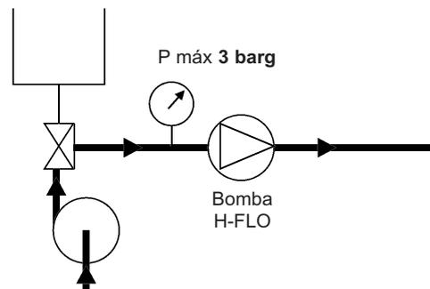
Es preferible no hacer girar la bomba H-FLO durante el CIP, pero se acepta una velocidad (< 100 rpm) o funcionamiento /parada alternada.
