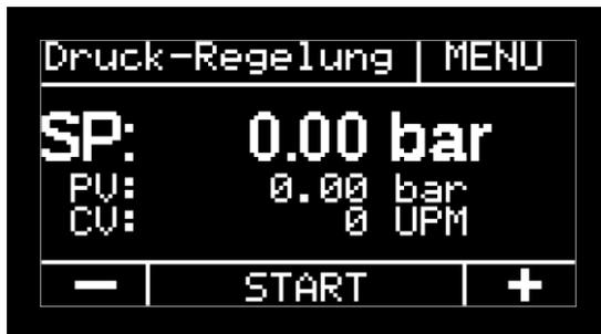
Abbildung 53 Druck-Regelung; Hauptfenster (Beispiel)
