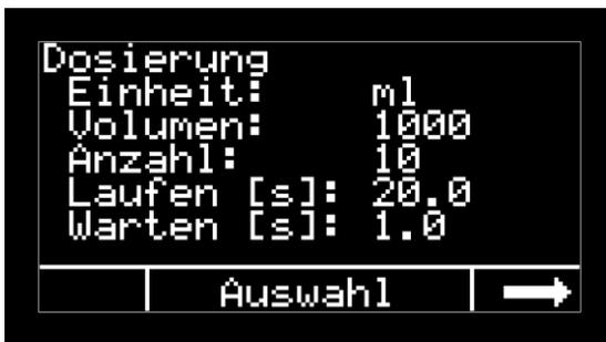
Abbildung 45 Konfiguration Dosierung (Beispiel)
