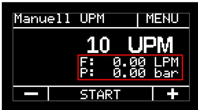
Abbildung 37 Manuell UPM; Anzeige der Sensorwerte (Beispiel)
